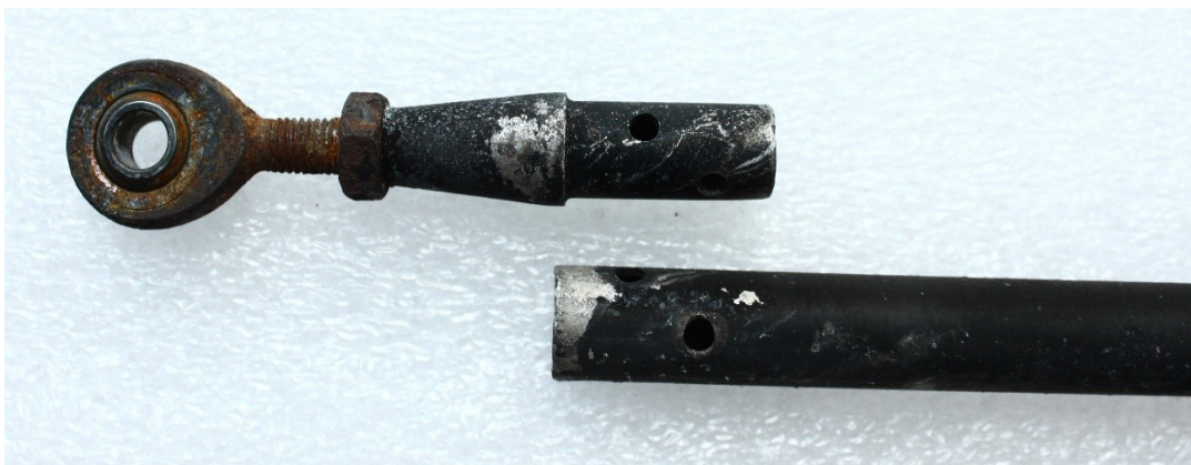
Obr. 11 - Detailní snímek dílu z havarovaného UL letounu
