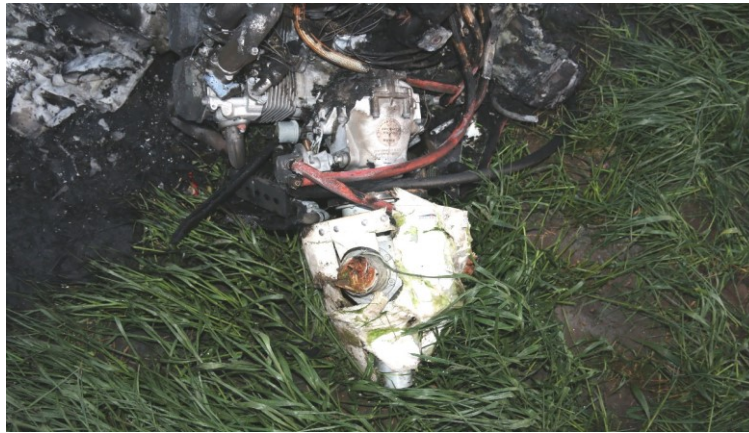
Obr. 6 - Poškozená pohonná jednotka
