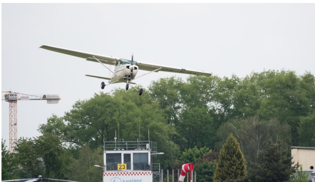
Obr. 1 – Letoun krátce po vzletu po minutí TWR, kdy po ztrátě výkonu přestal stoupat.
