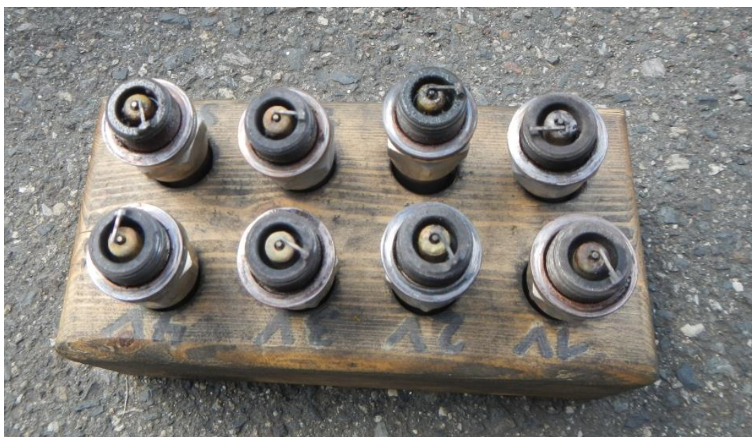
Obr. 6 – Stav zapalovacích svíček motoru Lycoming O-235 – L2C s. č. L 1177015.
