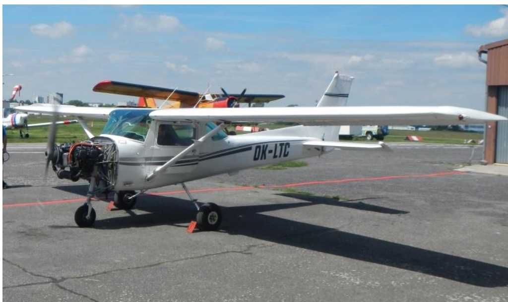
Obr. 7 – Motorová zkouška motoru Lycoming O–235 – L2C s. č. L 1177015 namontovaném na letounu „OK-LTC“ na LKLT dne 31. 5. 2019.
