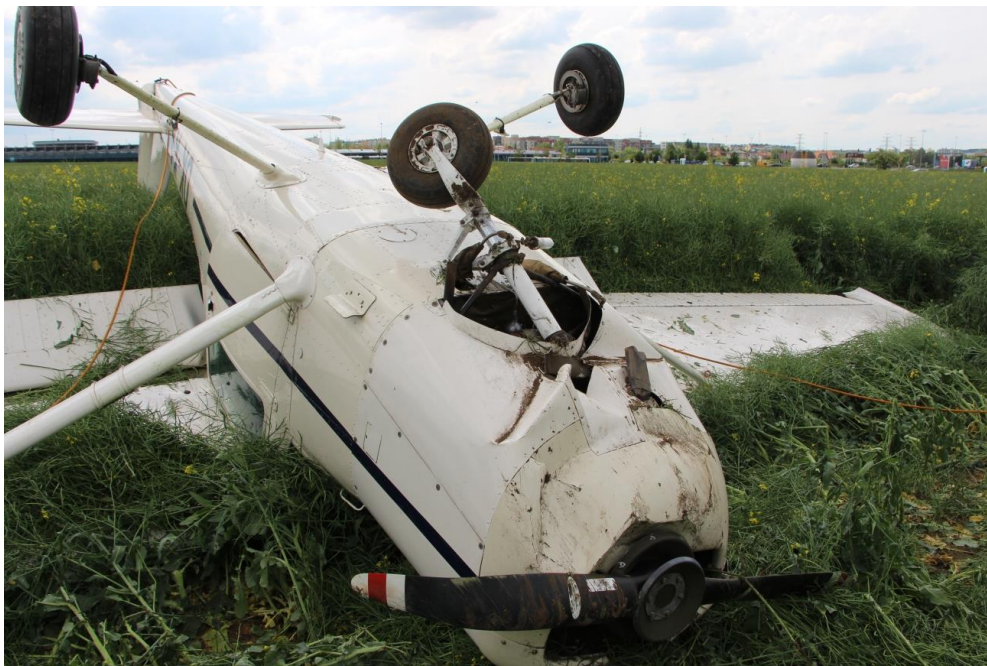
Obr. 4 – Poškozená před letounu s vylomenou přední podvozkovou nohou.
