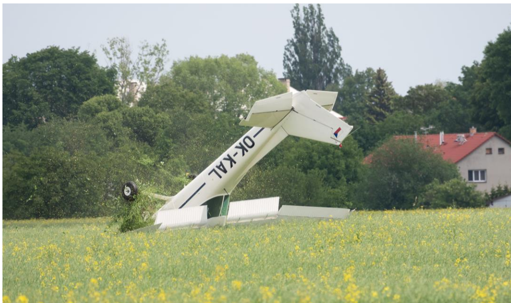
Obr. 3 – Převrácení letounu po „zachycení“ přední podvozkové nohy. hustým porostem brukve řepky olejně.
