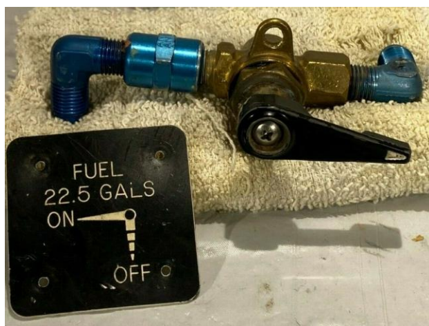
Obr. 8 – Dvoupolohový palivový kohout s popisným štítkem.
