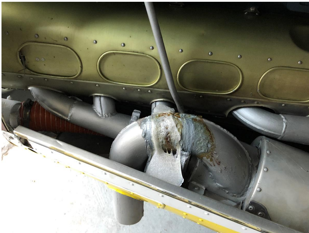
Obr. 2 – Roztavený uvolněný plastový deflektor na výstupu z tlumiče výfuku.
