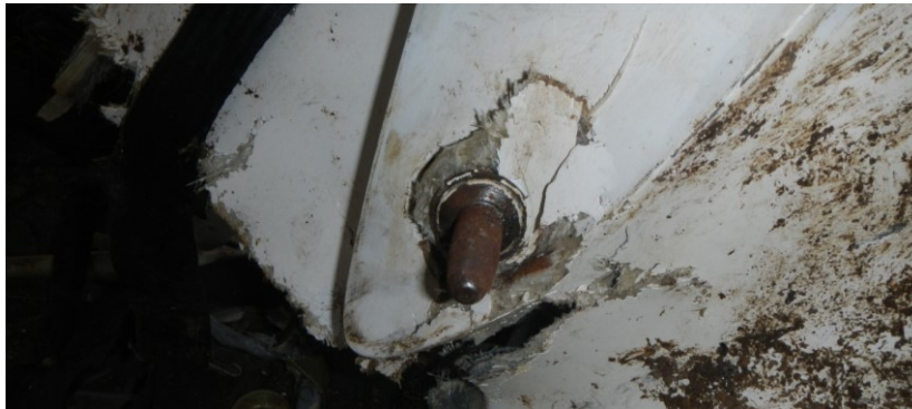
Obr. č. 10 – Přední vodící čep (trn) na pravém nultém žebře v trupu.
