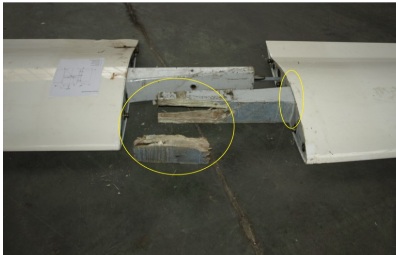
Obr. č. 17 - Poškození nosníku levé poloviny křídla.
