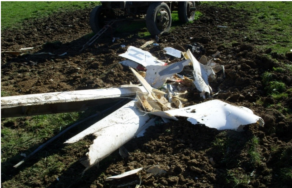
Obr. č. 2 - Trosky trupu kluzáku SZD-42-2 Jantar 2B na místě letecké nehody.
