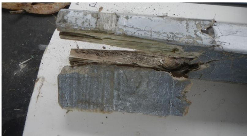
Obr. č. 12 – Poškozený konec nosníku levé poloviny křídla.
