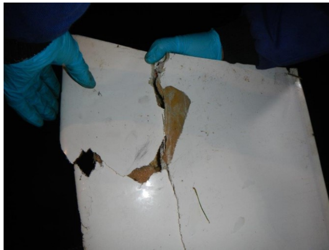
Obr. č. 9 - Poškozené výškové kormidlo s úlomkem.
