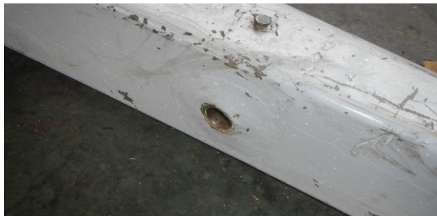
Obr. č. 11 – Nepoškozený konec nosníku pravé poloviny křídla s pouzdem pro hlavní spojovací čep.
