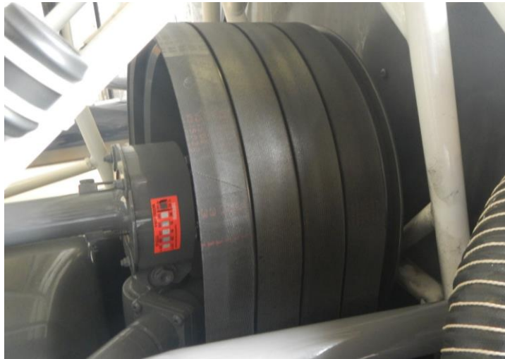
Obr. č. 7 – Posunutý řemeny na hnané řemenici
