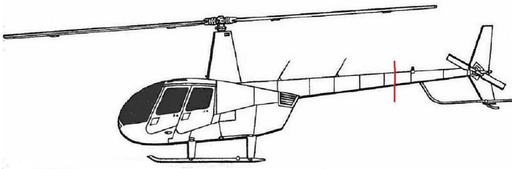
Obr. č. 6 – Červenou čarou je označeno místo, kde došlo k lomu ocasního nosníku.
