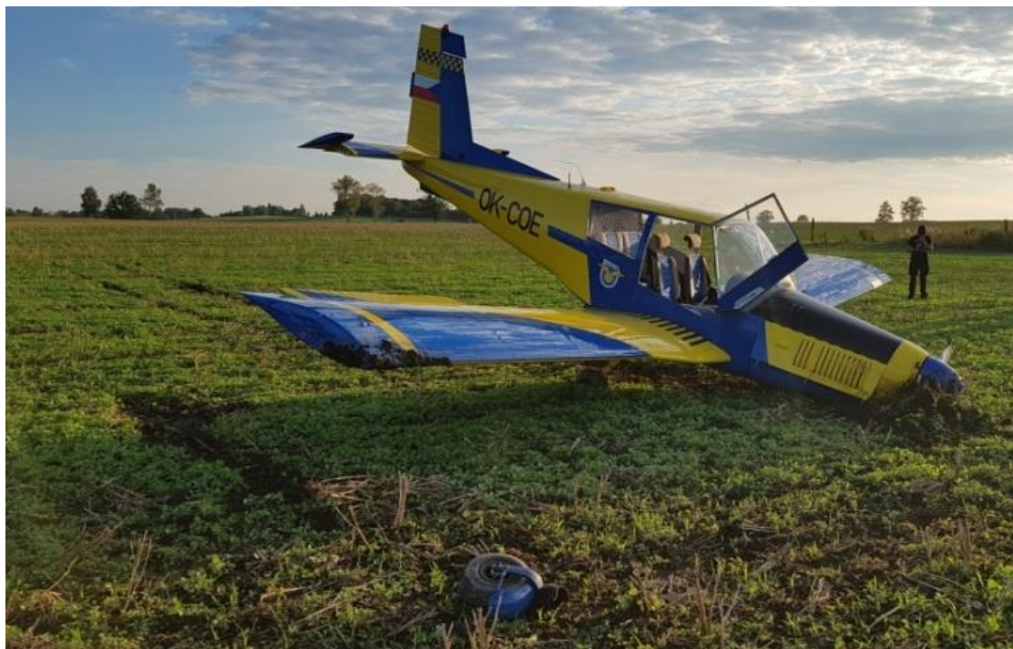
Obr. 2 – Letoun Z-43. V popředí je ulomené kolo předového podvozku.
