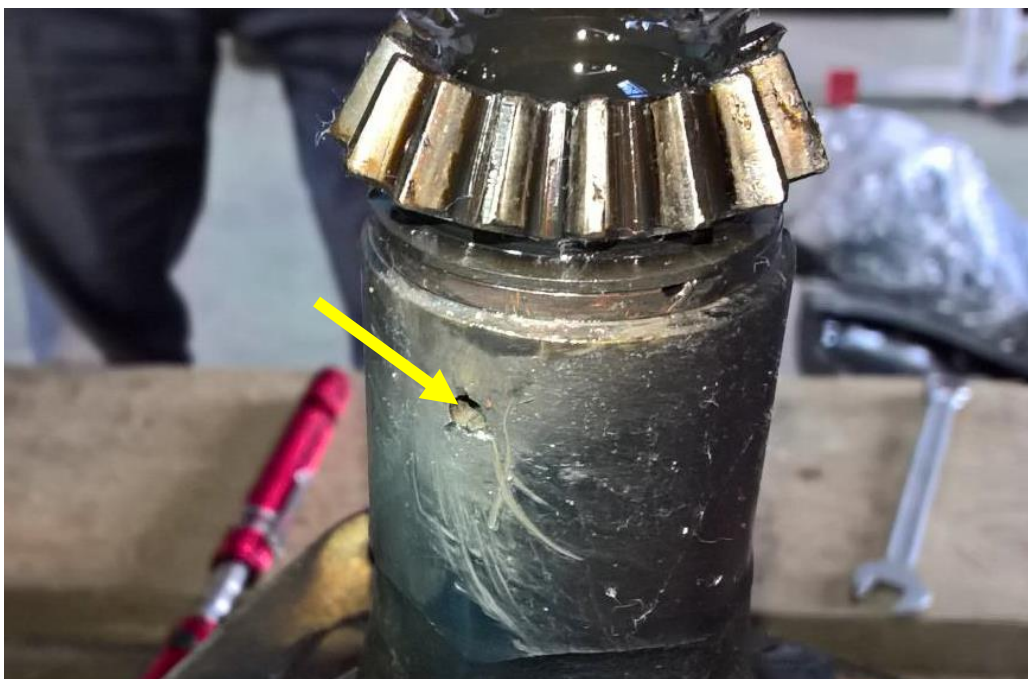
Obr. 6 – Otvor po vypadlém pojišťovacím kolíku (Pozice 2.)
