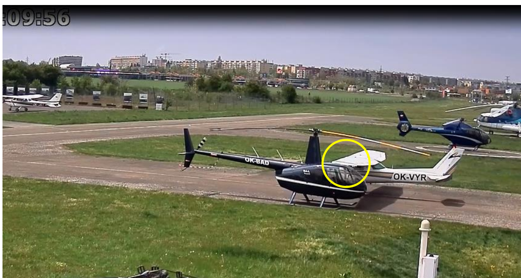
Obr. 2 – První náraz letounu OK-VYR na kabinu vrtulníku OK-BAD (záznam bezpečnostní kamery).
