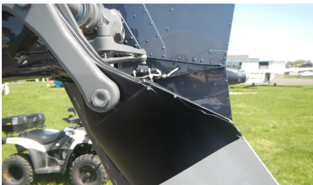
Obr. 10 – Poškozený vyrovnávací ocasní rotor.
