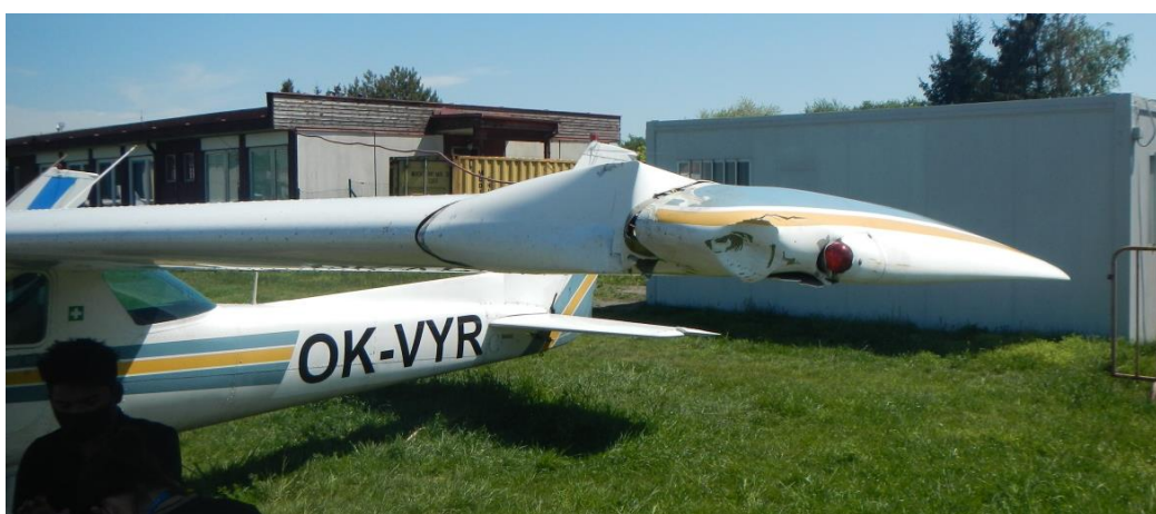
Obr. 6 – Poškozený konec levé poloviny křídla letounu F152 OK-VYR.
