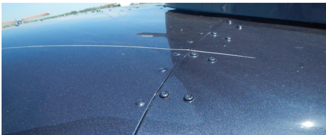
Obr. 8 – Prvním místem kontaktu byl vryp na kabině vrtulníku o délce přibližně 60 cm.
