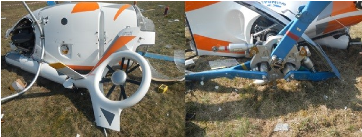
Obr. č.4: Poškození vrtulníku – vlevo spodní část trupu; vpravo rotorová hlava s listy nosného rotoru
