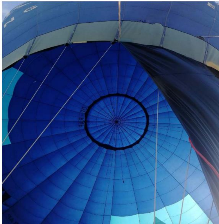
Obr. č. 9 – Pohled do obalu na vypouštěcí ústrojí
