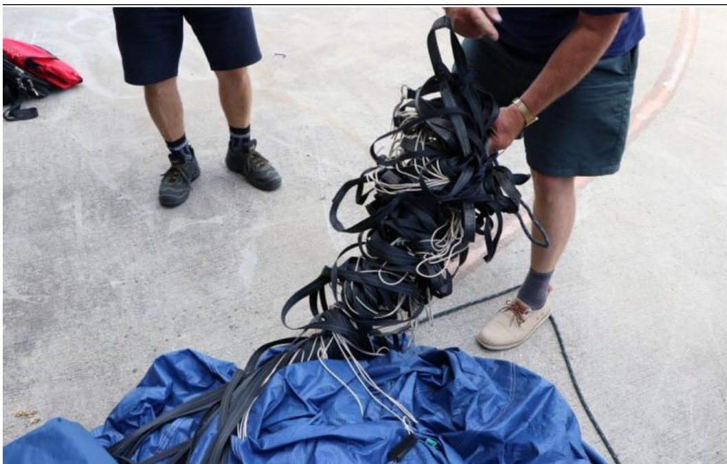
Obr. č. 5 - Stav ovládacích lanek, popruhů a centrovacích šňůr při ohledání balónu
