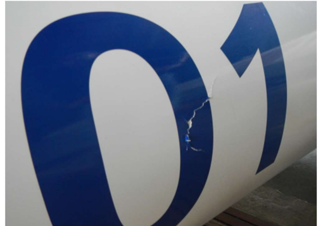
Obr.6 - Poškození kluzáku – pravá strana trupu
