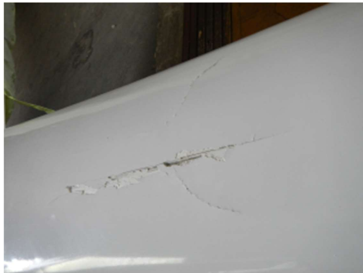
Obr.7 - Poškození kluzáku – horní část trupu
