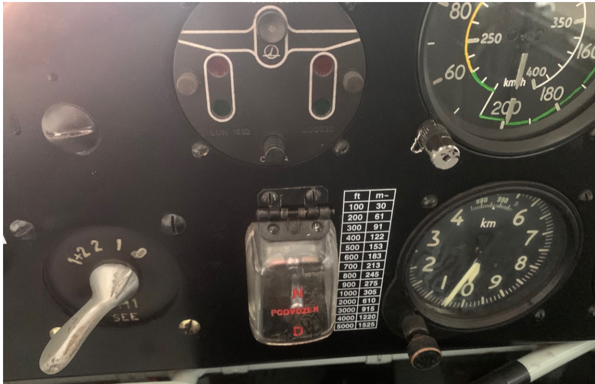
Obr. č. 2 – Přepínač ovládání polohy hlavního podvozku pod krytkou
