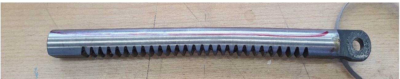
Obr. č. 6 – Poškození hřebenového táhla převodu elektromechanismu.
