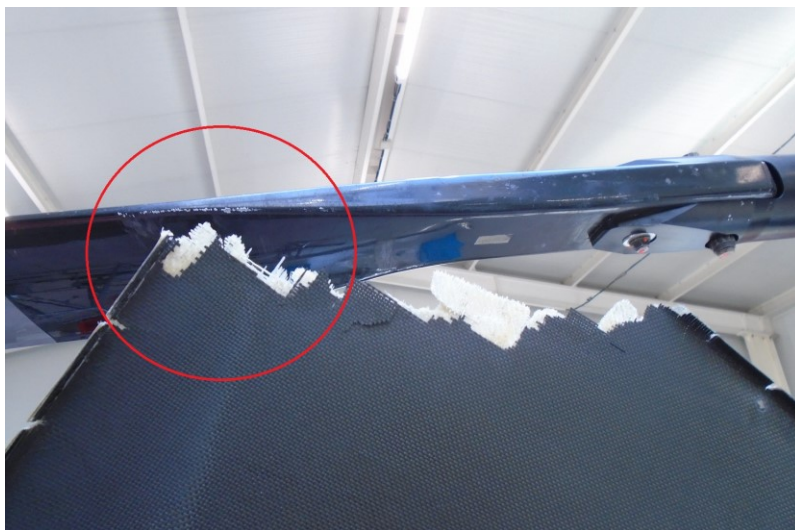
Obr. č. 9 – Poškození náběžné hrany listu hlavního rotoru motorovým krytem
