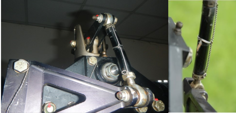
Obr. č. 8 – Poškozená hlava hlavního rotoru a táhlo ovládání listu
