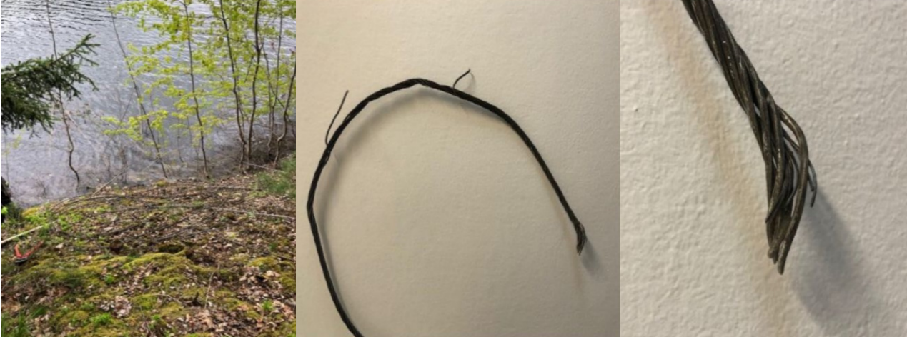
Obr. č. 6 – Přeseknutý konec vodiče na pravém břehu
