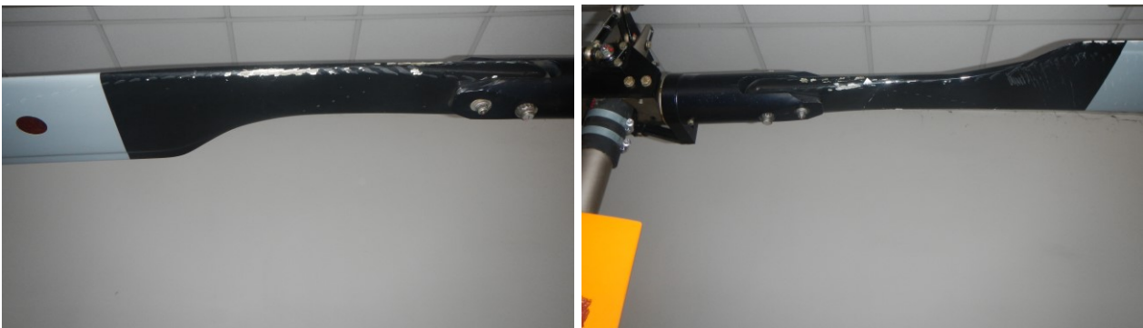
Obr. č. 7 – Poškozená náběžná a odtoková hrana jednoho listu
