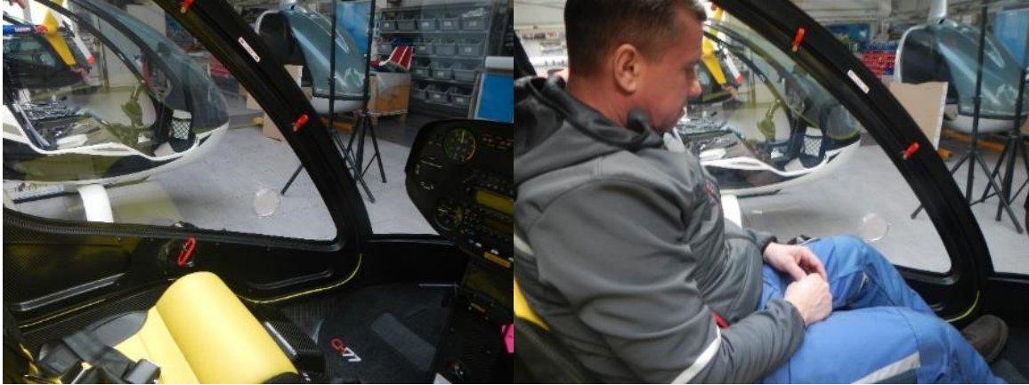
Obr. č. 19 – Pohled z místa pilota na ovládací prvky zavírání levých dveří
