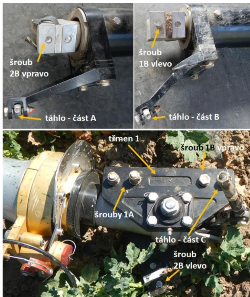
Obr. 15 – Přehledové snímky jednotlivých listů hlavního rotoru (č. 1 vpravo a č. 2 vlevo) a hlavy rotoru (dole) UL vrtulníku CH 77 RANABOT s popisem označení jednotlivých analyzovaných dílů.
