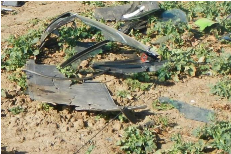
Obr. č. 12 – Nález fragmentů levých dveří na místě nehody (klika v poloze otevřeno)
