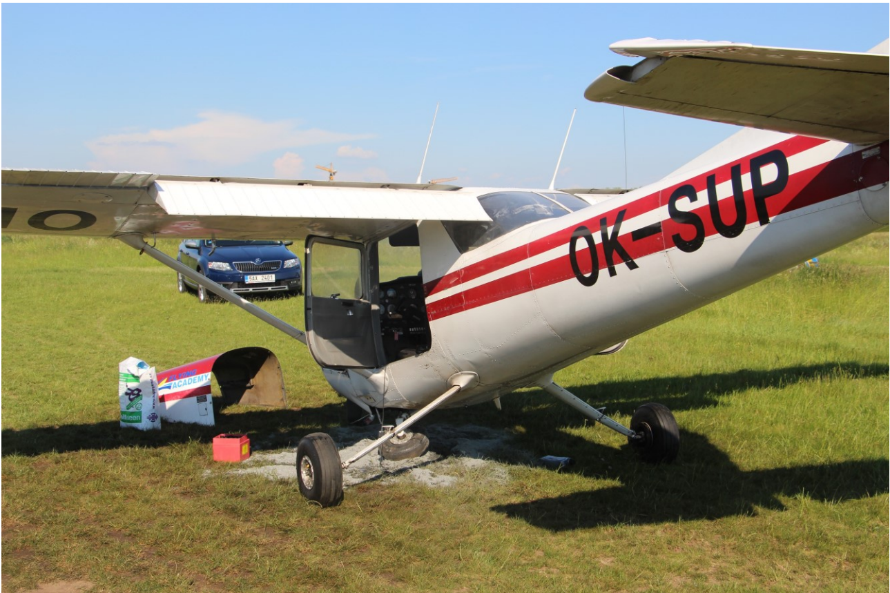
Obr. 9 Poloha vztlakových klapek nastavených na 30°
