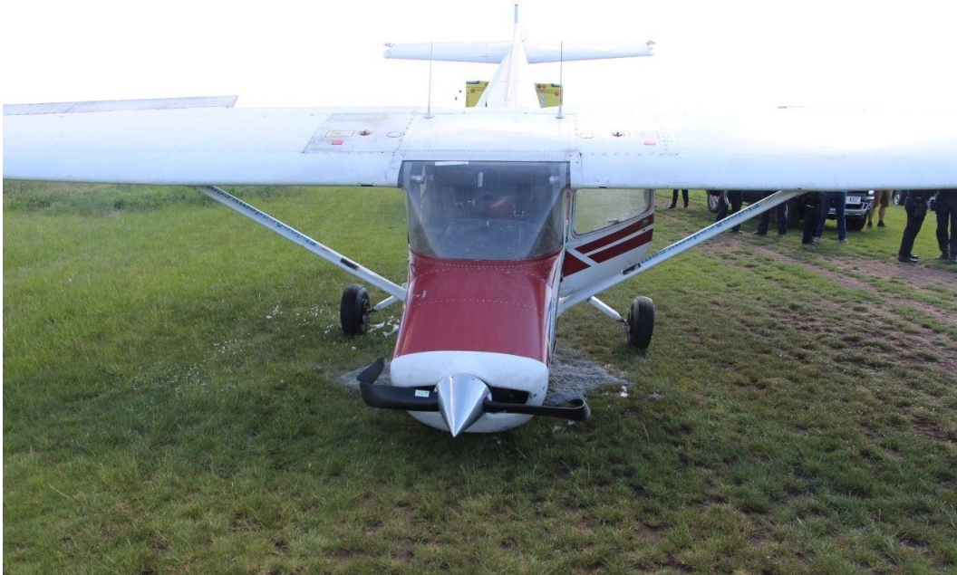
Obr. 7 Poloha letounu po LN, vrtule po kontaktu s RWY
