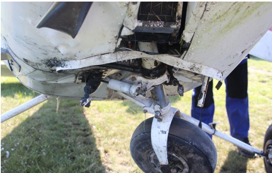
Obr. 8 Vylomený předový podvozek
