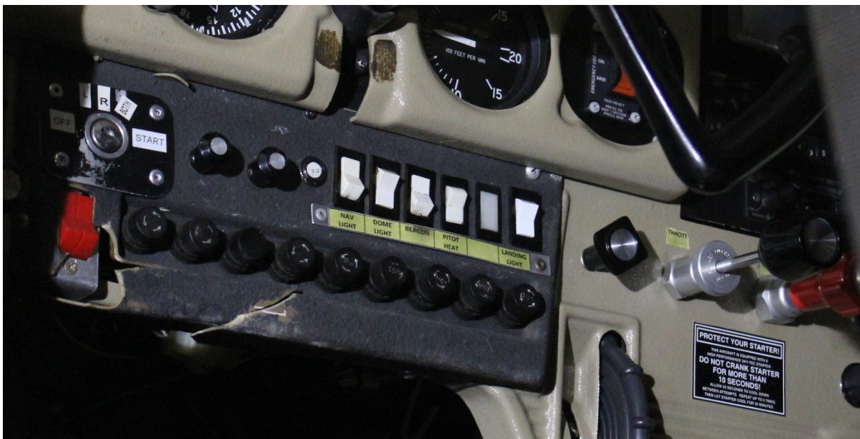
Obr. 5 – Poloha spínačů a ovládacích prvků motoru při ohledání místa LN
