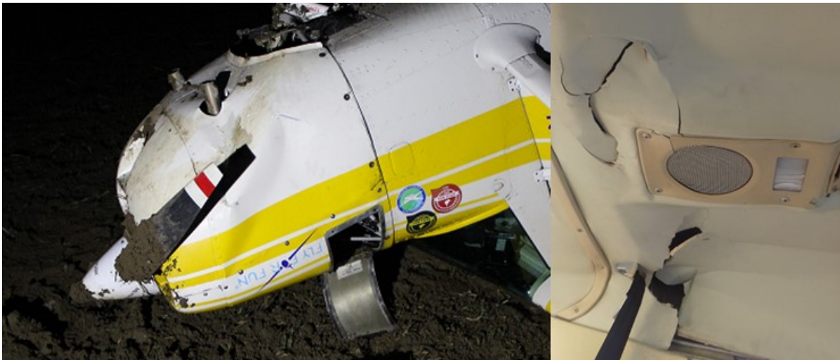
Obr. 4 – poškození kapotáže motoru, poškození vrtule (vlevo), poškození vnitřního polstrování (vpravo)
