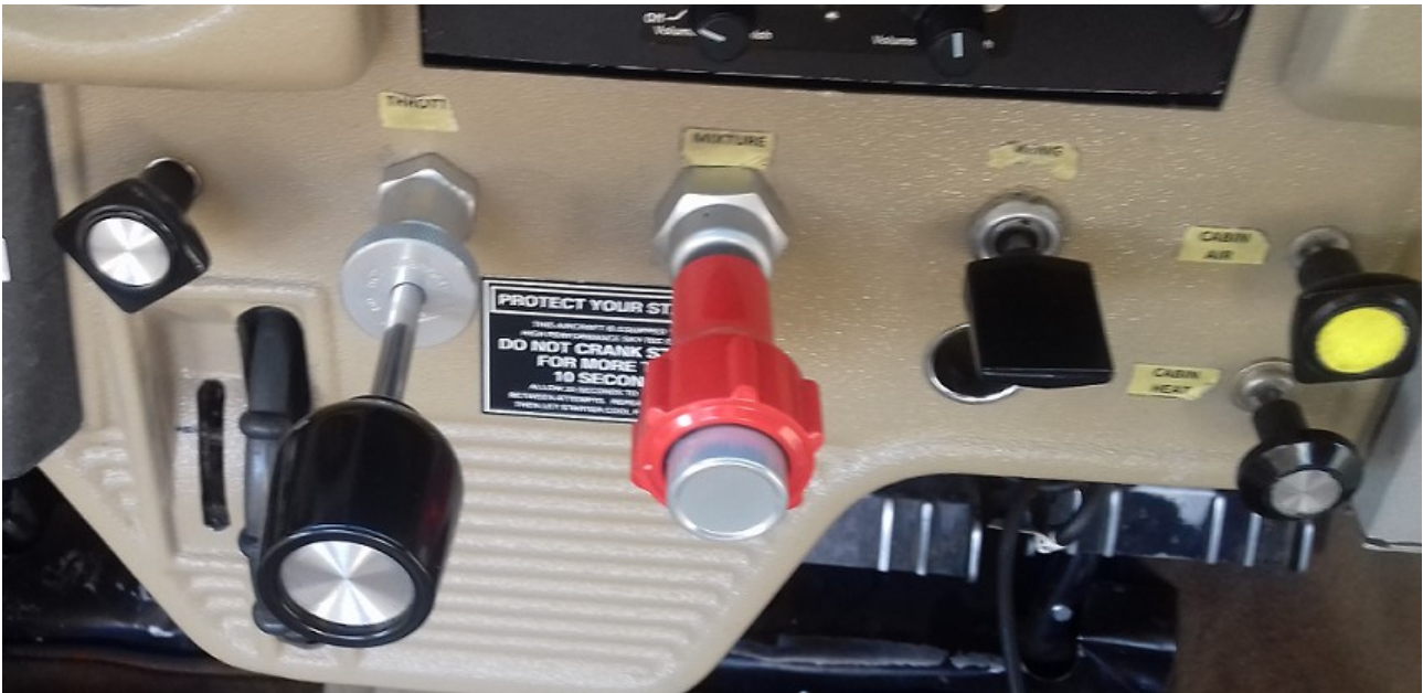
Obr. č. 8 – Ovládací prvky motoru a vyhřívání a jejich označení v letounu OK-MRK
