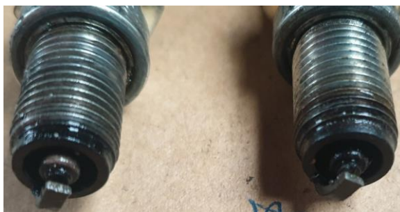
Obr. č. 6 – Dokumentuje stav zapalovacích svíček. Jiskříště svíček bylo silně znečištěno karbonovými usadami, které svědčí o použití příliš bohaté směsi
