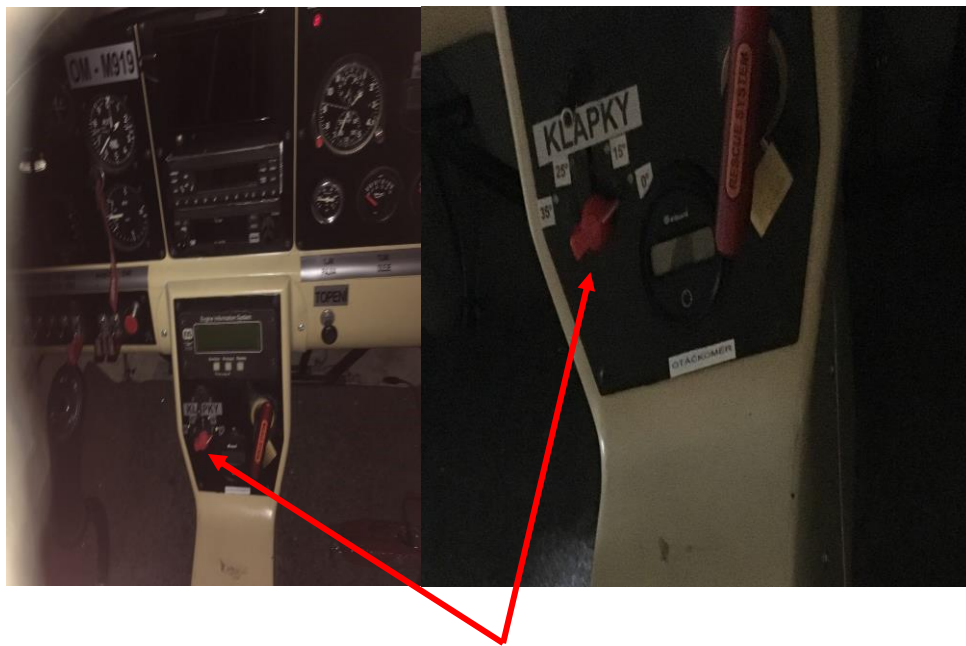
Obr. č. 11 – Ovládání vztlakových klapek
