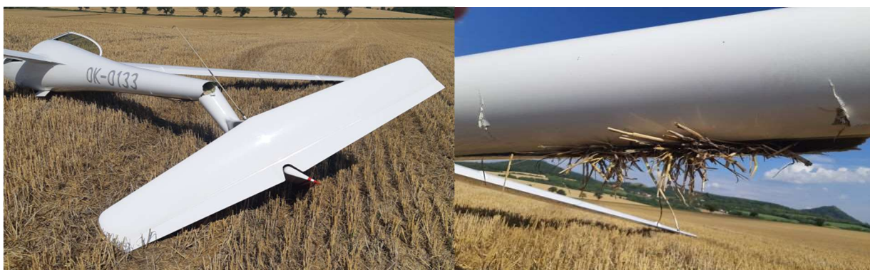
Obr. č. 4 – Poškození kluzáku.
