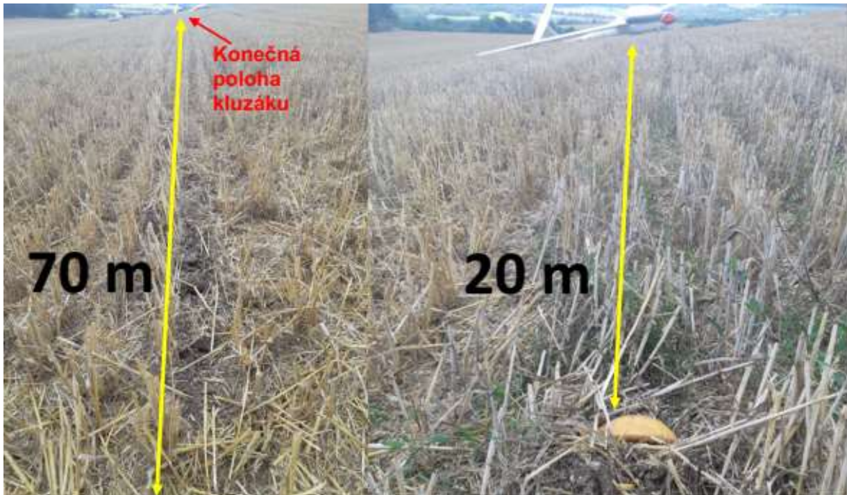
Obr. č. 3 – Stopy pohybu kluzáku po poli od jeho prvního kontaktu se zemí (na obrázku vlevo) a konečná poloha kluzáku, v popředí s ulomenou koncovou částí pravé poloviny křídla (na obrázku vpravo).
