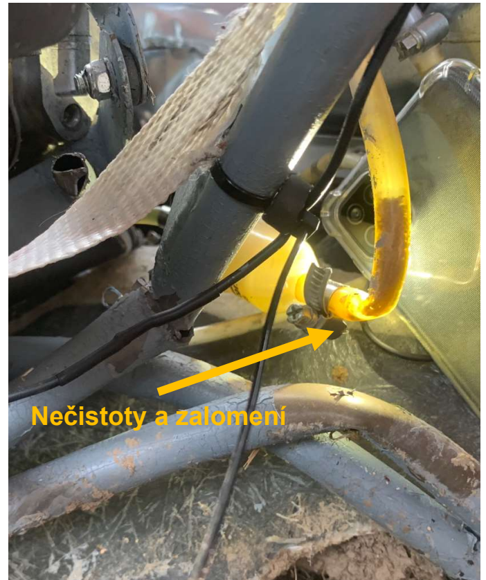
Obr. 10 a 11: Pevné nečistoty a zalomení hadičky v palivové soustavě nalezené během kontroly v depozitu ÚZPLN
