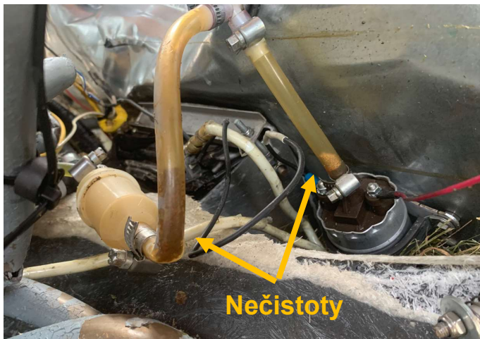
Obr. 10 a 11: Pevné nečistoty a zalomení hadičky v palivové soustavě nalezené během kontroly v depozitu ÚZPLN
