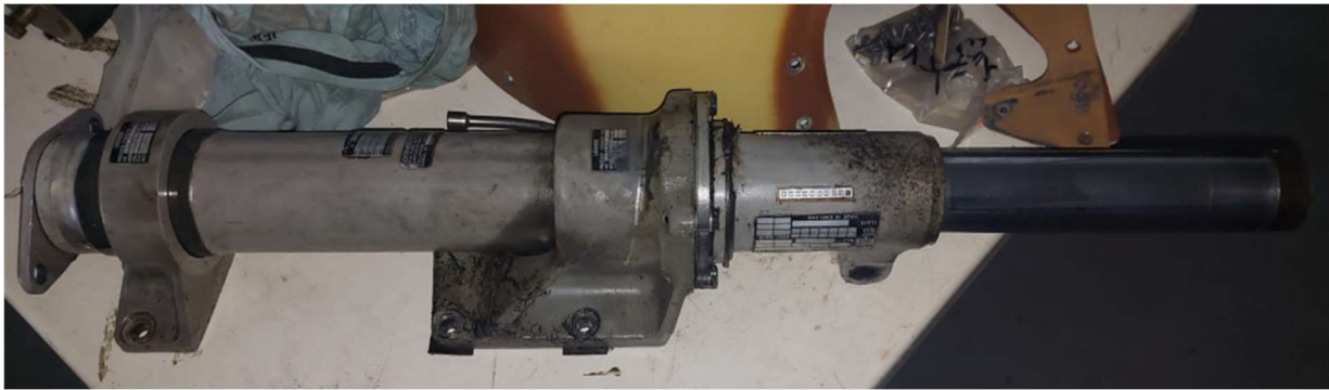
Obr. č.4 – Zlomená stojina přední podvozkové nohy
