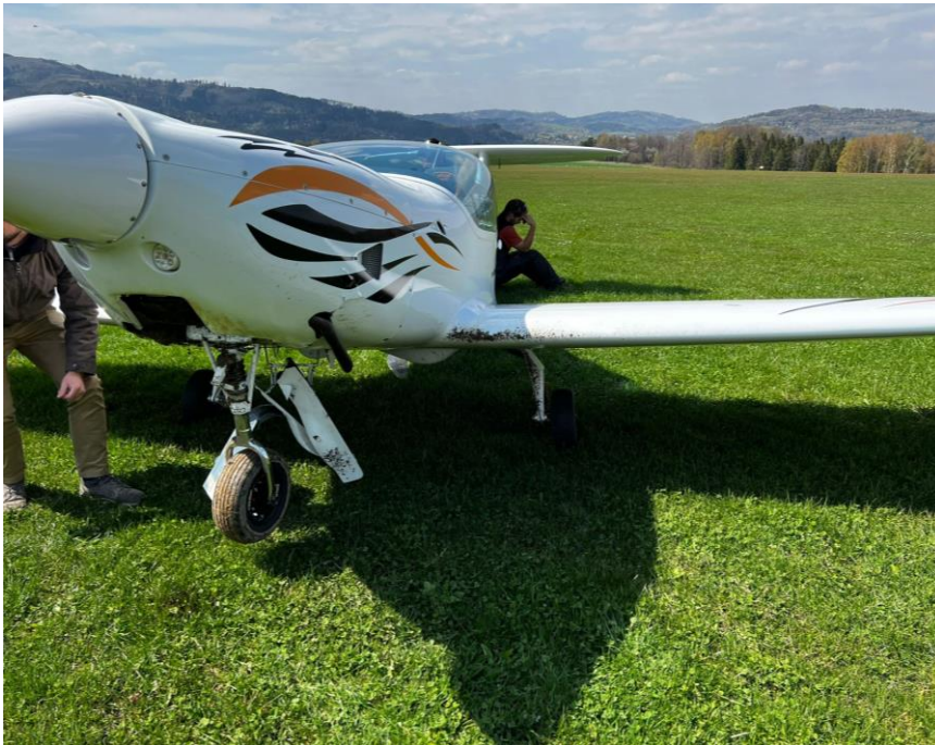
Obr. č. 1 – Poškození předového podvozku UL letounu
