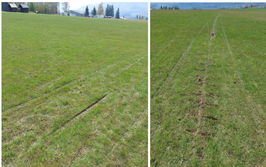
Obr. č. 2 – Stopy podvozku a záseky vrtule v rozmoklé travnaté dráze
