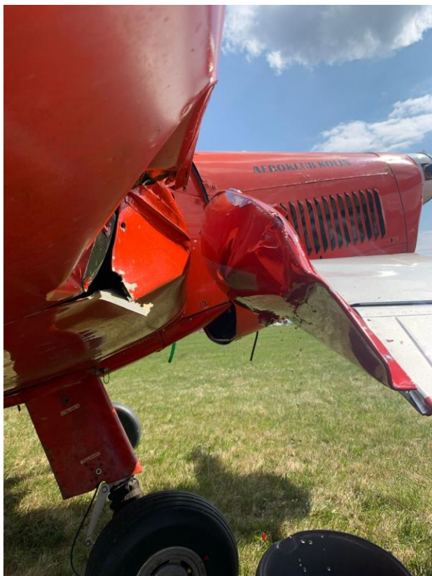
Obr. 4, 5 – Poškození pravé poloviny křídla a vrtule Zlínu Z 226 OK-KMP.
