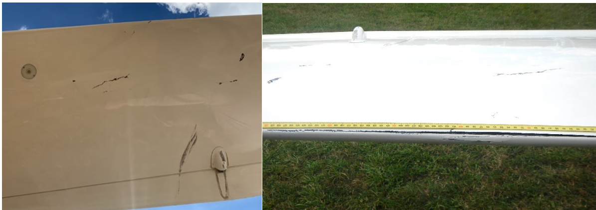
Obrázek 11 – Poškození náběžné hrany a spodní strany levé poloviny křídla kluzáku 1X
