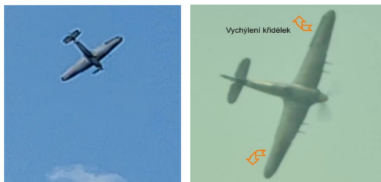
Obr. č. 2 – Vychýlení křidélek ve smyslu proti klonivému pohybu v klesavé zatáčce.
