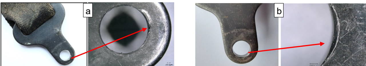
Obr. č. 7 – Zadní strany spon ramenních pásů; (a) pravý pás; (b) levý pás
