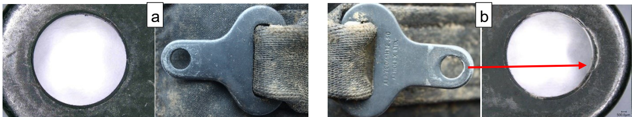
Obr. č. 5 – Pravá spona břišních pásů; (a) přední část pravé spony; (b) zadní část pravé spony.
