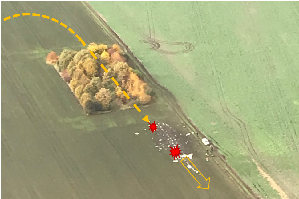
Obr. 3 – Místa dopadu UL letounu a šipka ukazující směr aktivace záchranného systému
