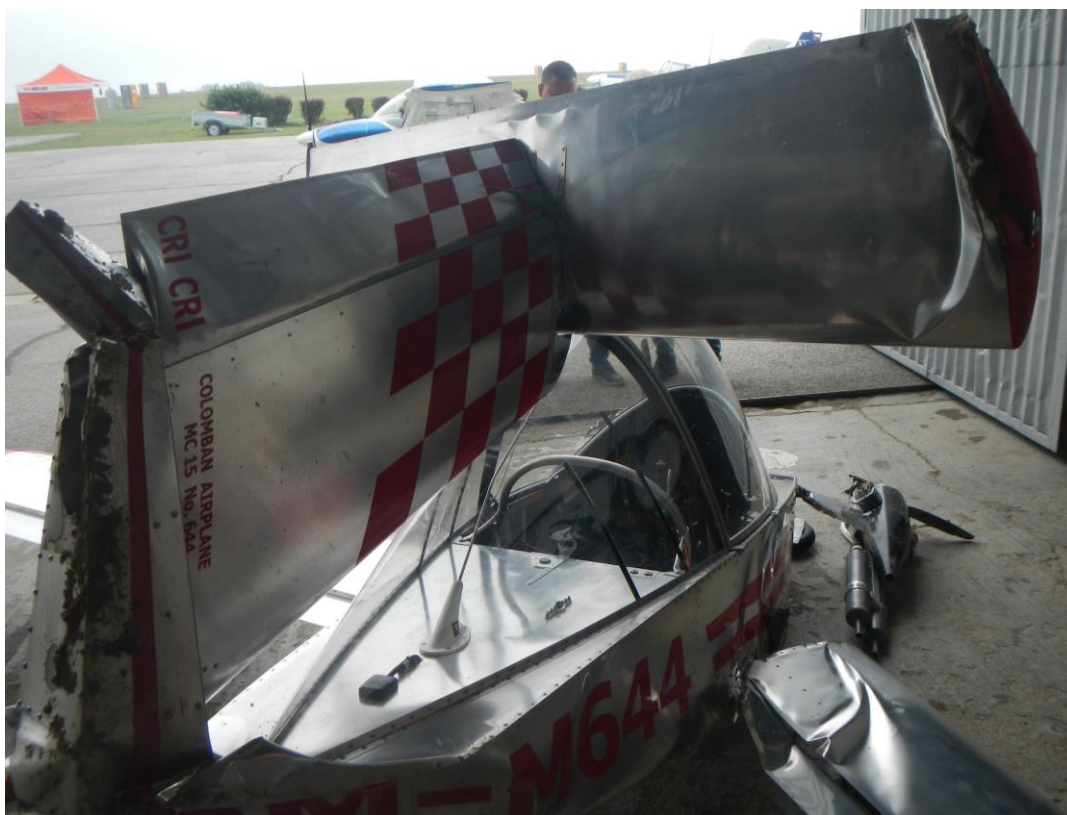
Obr. 5 – Zlomená zadní část trupu s ocasními plochami. Vpravo leží utržený pravý motor a ulomená pravá polovina křídla.
