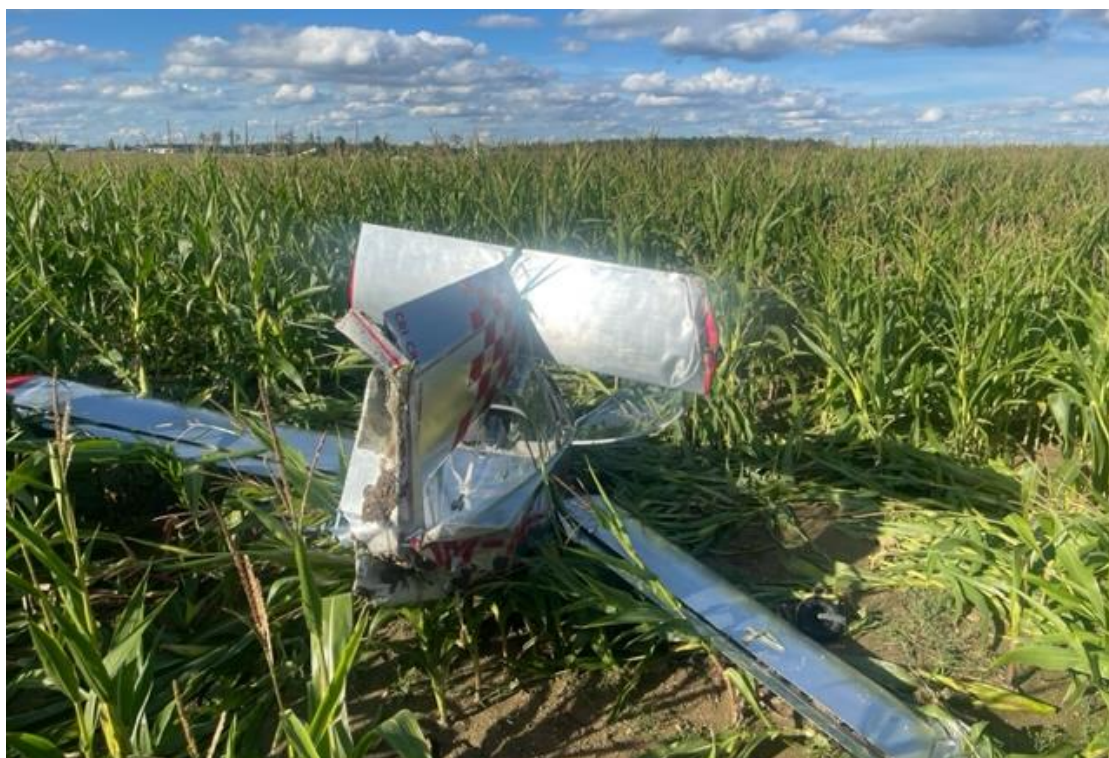
Obr. 3 – Ultralehký letoun Colomban MC-15. Pohled na zlomenou zadní část trupu.
