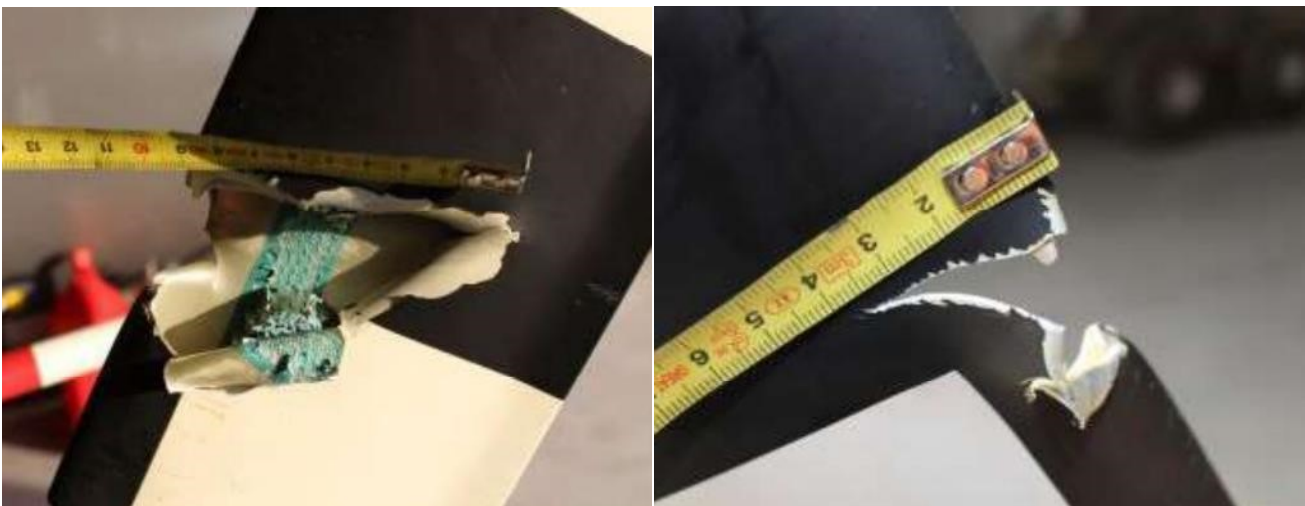
Obr. č. 14 – Oboustranné poškození listu ocasní vrtulky
