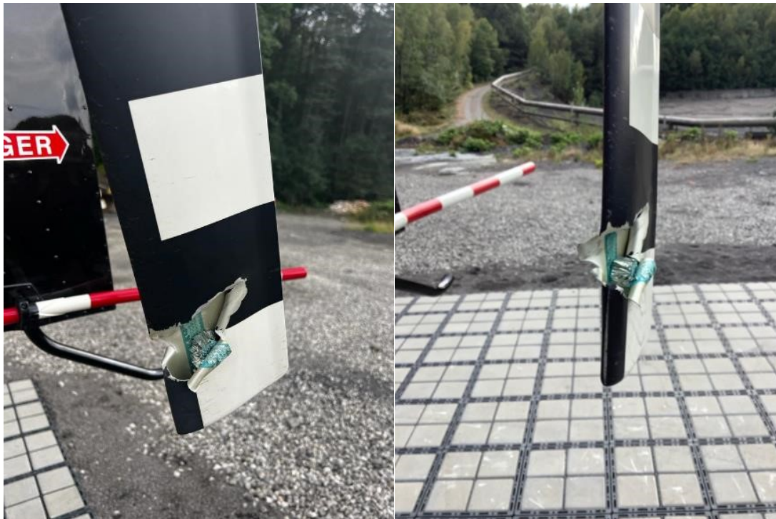
Obr. č. 7 – Poškozený list ocasní vrtulky (fotografie z místa přistání)
