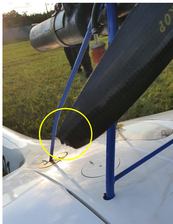
Obr. 9 – Poškozený list vrtule.
