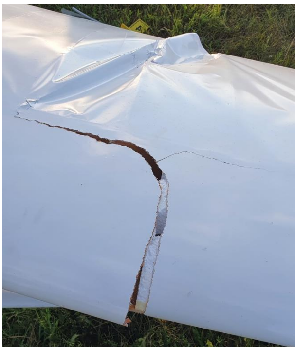
Obr. 8 – Poškození pravé poloviny křídla.
