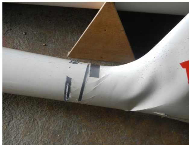
Obr. 11 – Místo, kde bylo izolepou přilepeno olovo.
