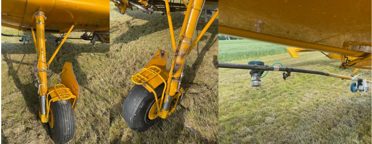
Obr. 1 – Poškození letounu (vlevo pravá podvozková noha, uprostřed levá podvozková noha, vpravo poškozené zařízení pro aplikaci prostředku k ošetření zemědělské plodiny)
