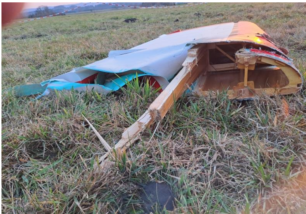
Obr. 6 – Zlomený hlavní nosník s podélným oddělením jednotlivých hranolů a s poškozeným žebrem č. 4. Charakter oddělení jednotlivých hranolů svědčí o velkém namáhání konce křídla na krut.
