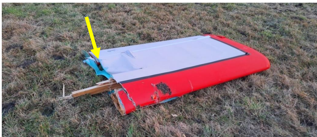
Obr. 5 – Ulomená část levé poloviny křídla. K ulomení došlo v místě konce pomocného nosníku (žlutá šipka).
