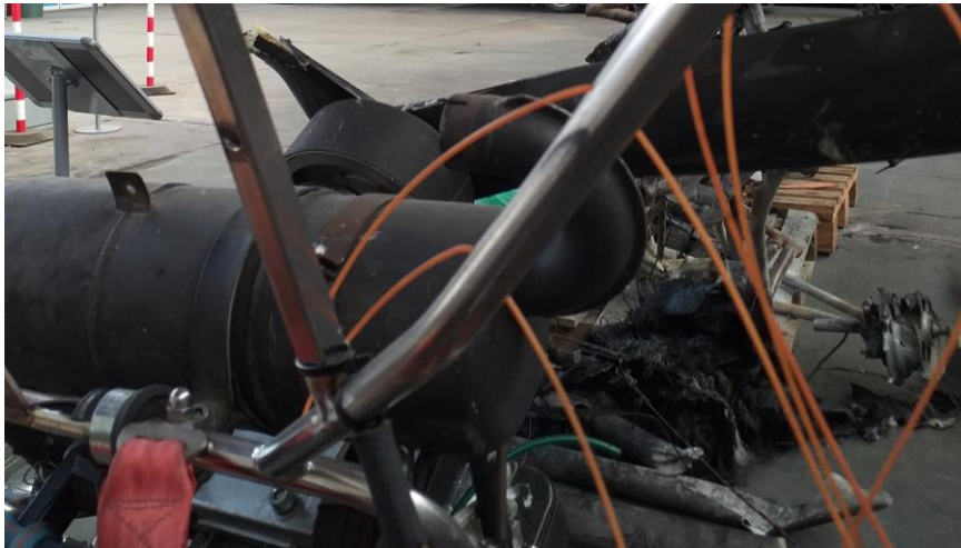
Obr. č. 5 – Otěr na trubce ochranného rámu vrtule
