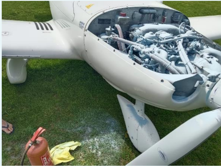
Motor vlečného UL letounu po uhašení
