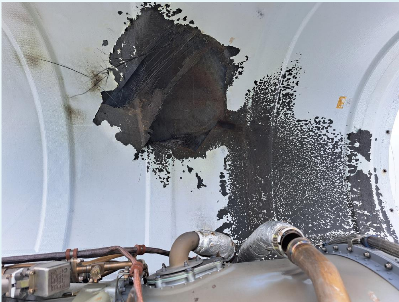
Poškození způsobené rozpojením vzduchového vedení na levém motoru
