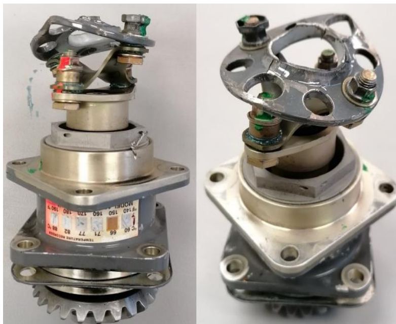
Obr. č. 5 – Spojení koncového reduktoru s transmisní hřídelí
