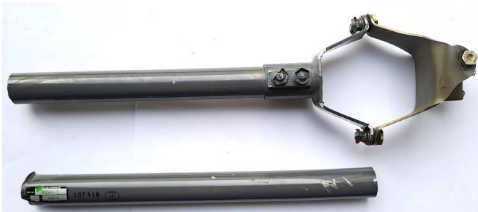
Obr. č. 6 – Poškození pružných spojek transmisního hřídele
