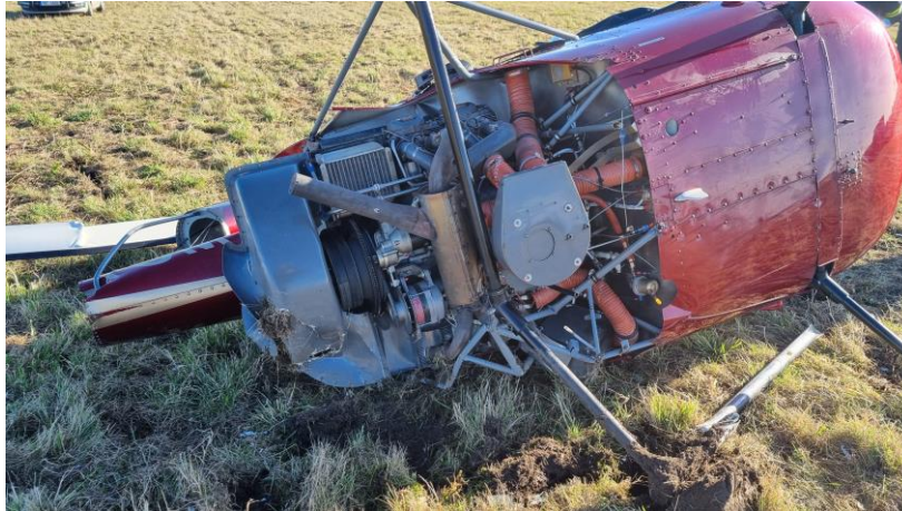
Obr. č. 4 – Poškození ližinového podvozku a levé zadní části trupu
