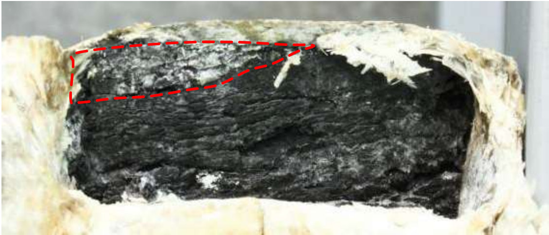
Obr. 5.6 – Detail lomu horní pásnice z vyznačenou oblastí podezřelou z nalomení při předchozí nehodě. V oblasti jsou zbytky pojiva z povrchové vrstvy skleněné tkaniny.
