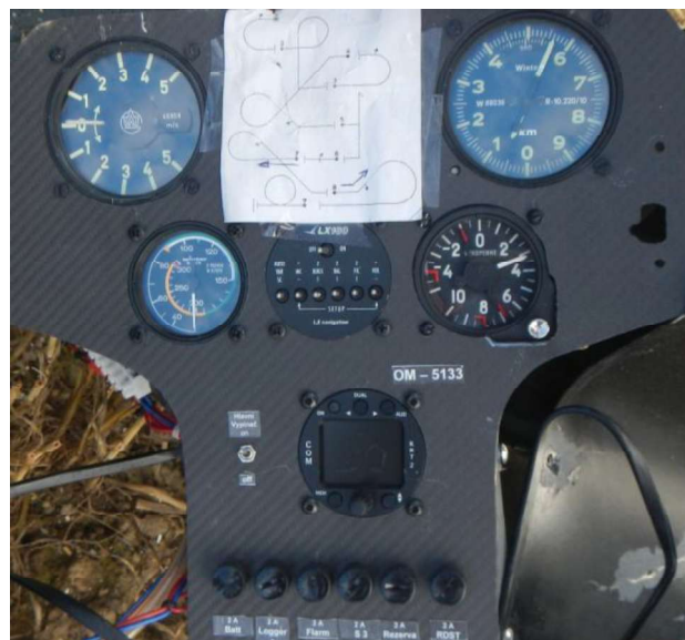
Obr. č. 11 – Přístrojová deska kluzáku po dopadu na zem
