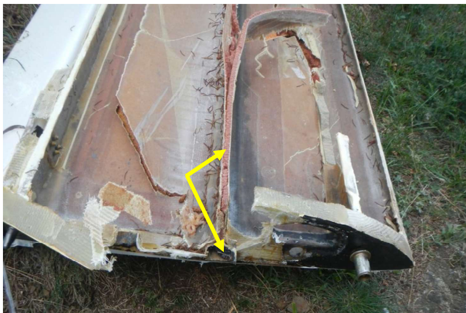
Obr. č. 13 – Levá polovina křídla se zbytky kořenového žebra. Zlomenou spodní pásnici a roztrženou stojinu pod horní pásnici nosníku ukazuje šipka
