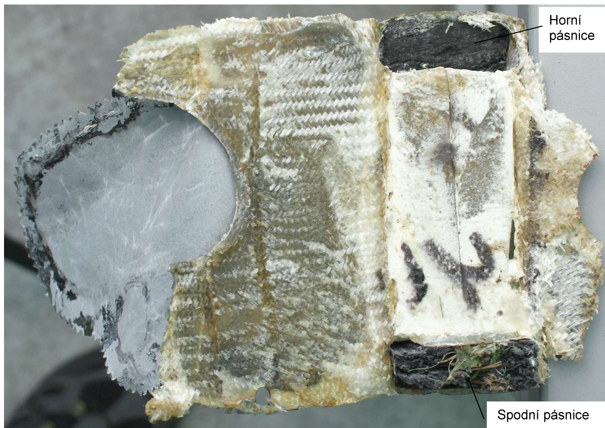
Obr. 5.1 – Přehledový snímek lomové plochy z pohledu do trupu.
