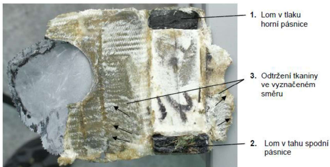
Obr. č. 14 – Pravděpodobná sekvence porušení nosníku levé poloviny křídla
