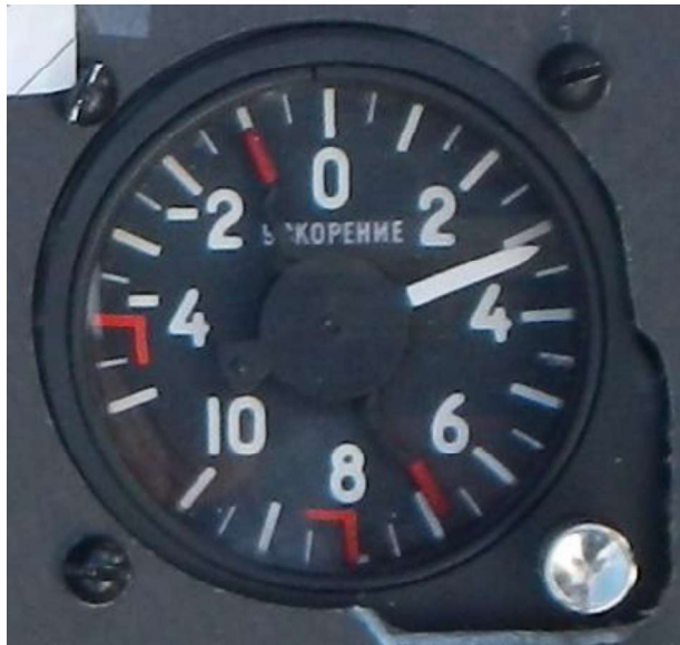
Obr. č. 17 – Hodnoty na G-metru po nárazu kluzáku do země
