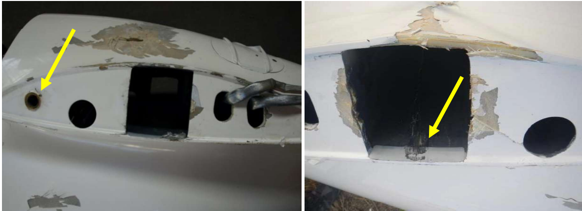
Obr. č. 10 – Levá a pravá část trupu profilovaná pro spojení polovin křídla v rovině kořenového žebra
