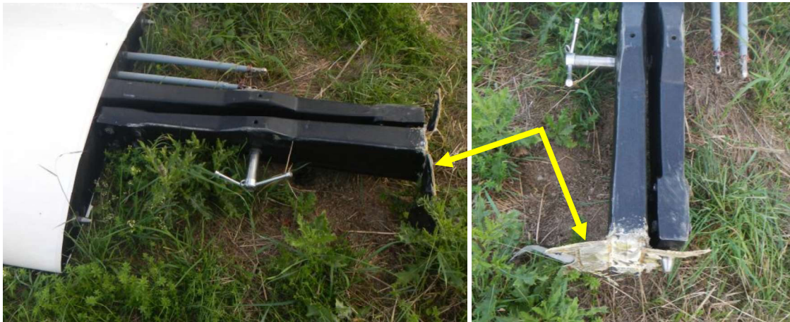
Obr. č. 12 – Zbytek kořenového žebra na nosníku levé poloviny křídla.
