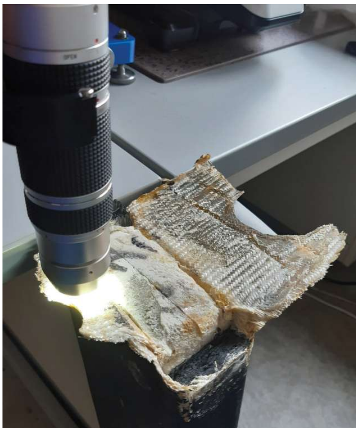
Obr. 4.1 – Pozorování lomu digitálním mikroskopem.
