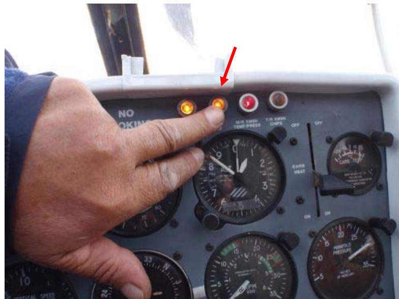
Test žárovky „PRESS TO TEST“ po nehodě – žárovka svítí.
