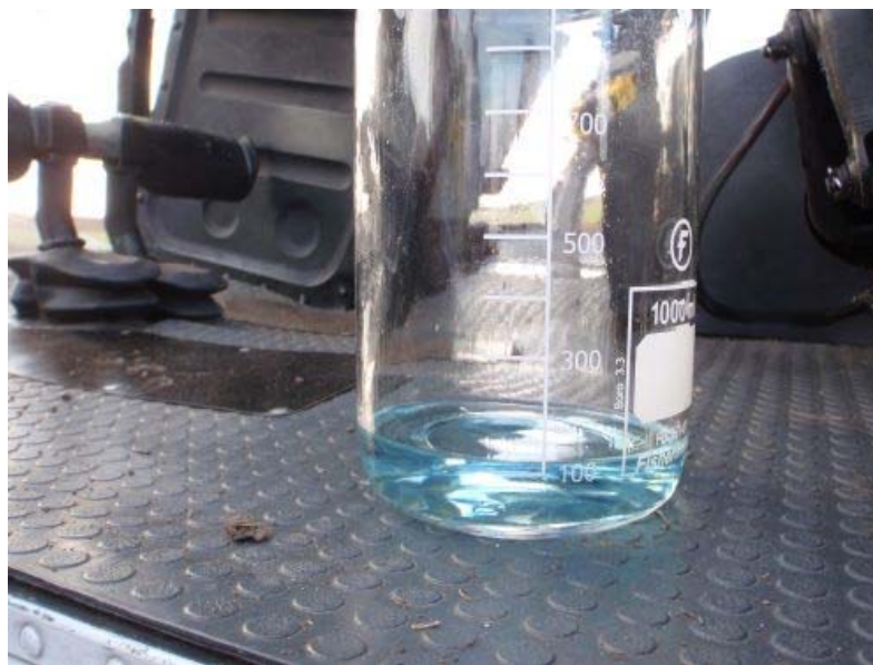
Celkové množství paliva vypuštěné po nehodě z palivové instalace.
