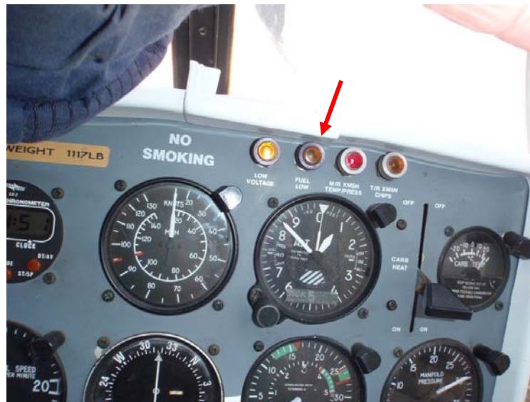
Stav žárovky „FUEL LOW“ při zapnutí el. instalace po nehodě – žárovka nesvítí
