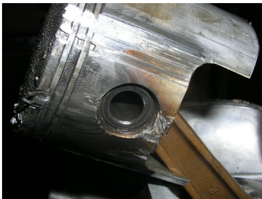
Obr. 2 Uvolněná pojistka pístního čepu
