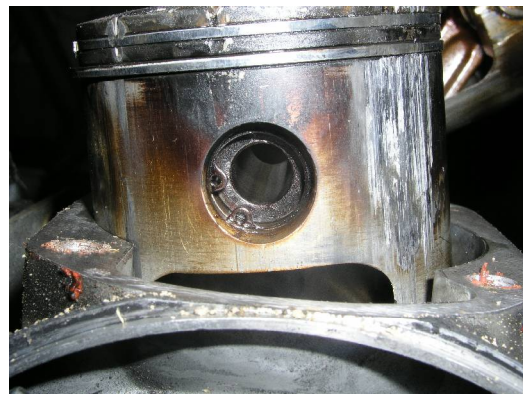
Obr. 3 Použití neoriginální pojistky
