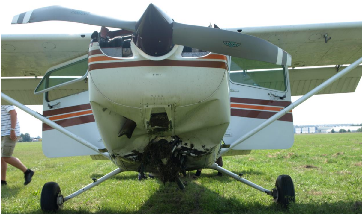
Poškození přední části trupu letounu.
