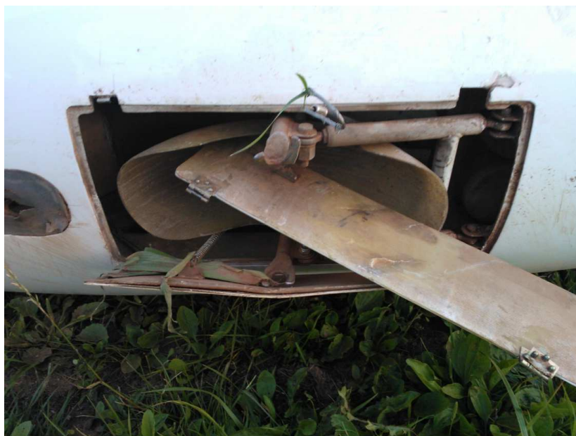
Obr. 2: Pohled na poškození krytů podvozkové šachty bez kola podvozku
