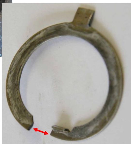
Poškození pojistné podložky č.v. Sc3752
