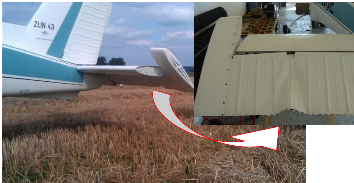
Poškození letounu po přistání a poškození levé části výškového kormidla.
