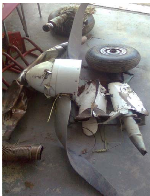
Poškození vrtule, podvozku a tlumiče výfuku.
