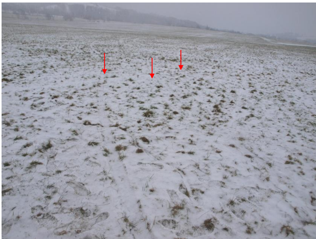
Pohled na povrch dráhy letiště, šipky označují stopy po odvalujících se kolech podvozku letadla.
