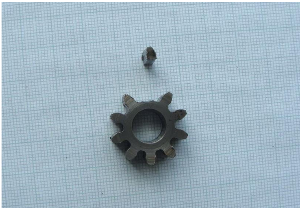
Obr. 4: Ulomený zub hnaného kola Sc3755 vratného olejového čerpadla ve vačkové skříně
