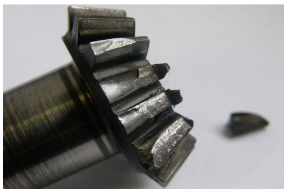
Poškozené zuby hřídele Sc3757
