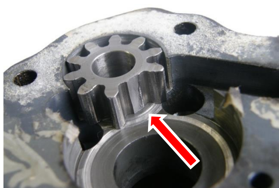
Poškozené hnané kolo Sc3755
