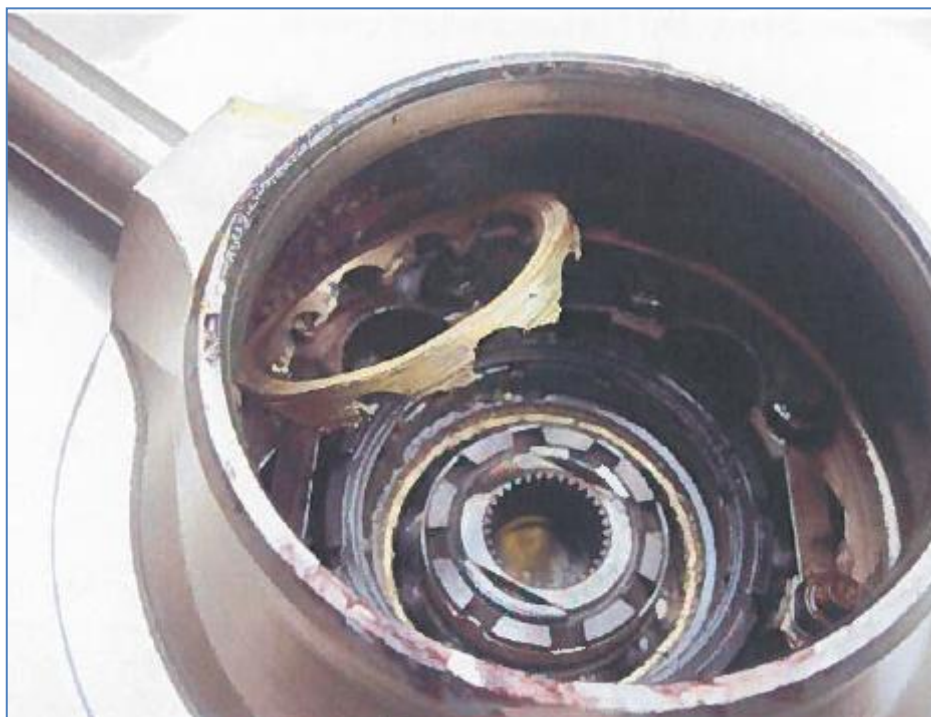
Poškození hlavního ložiska motoru M 601E
