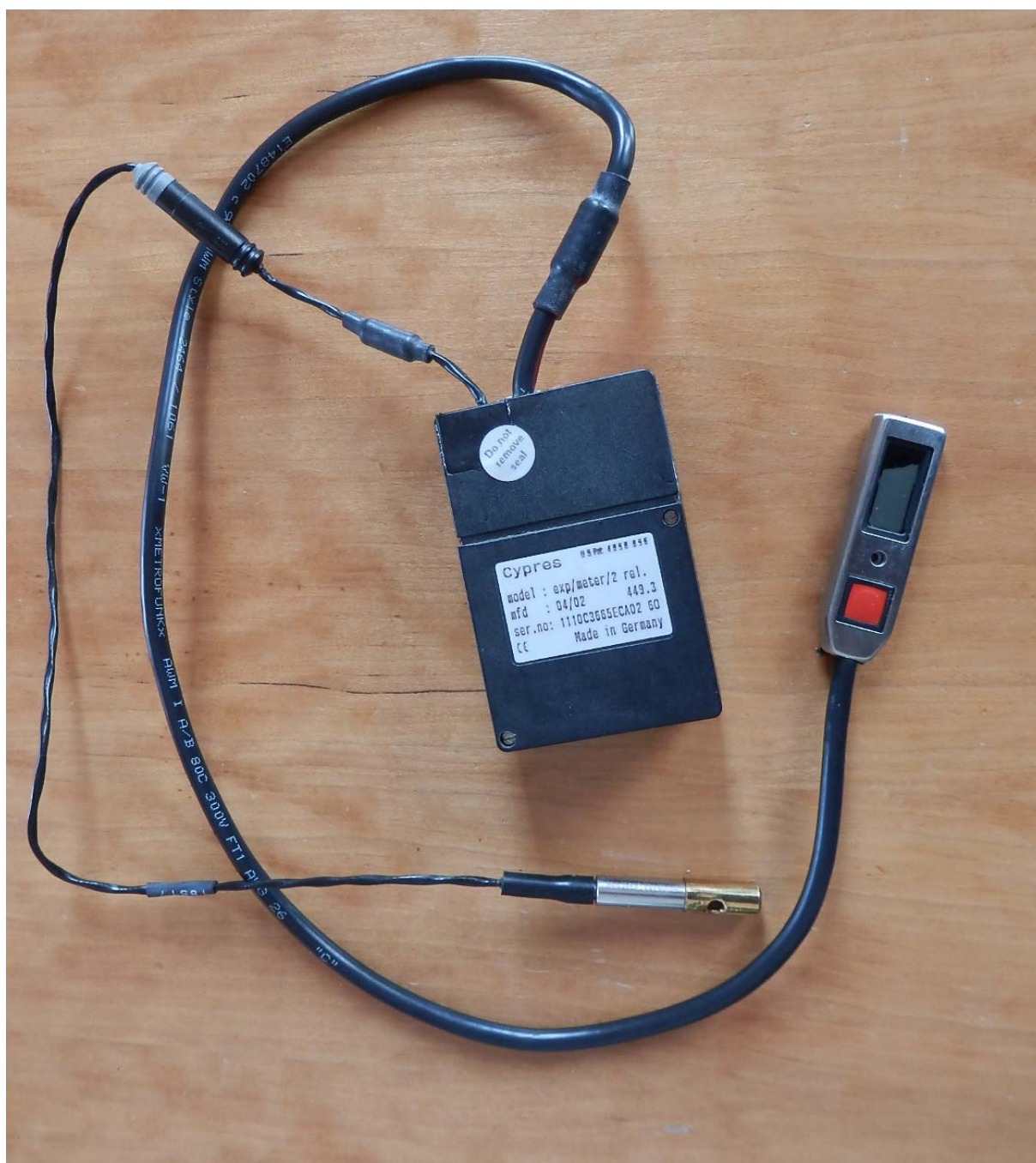
Obr. 4.: Záchraný přístroj CYPRES AAD 1 Expert
