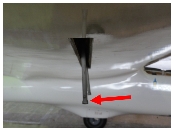
Deformace segmentu vzdušné brzdy a deformace táhla směrem vzad
