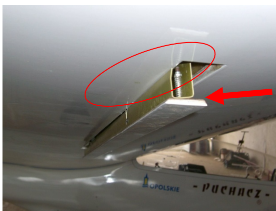
Deformace segmentu vzdušné brzdy a deformace táhla směrem vzad
