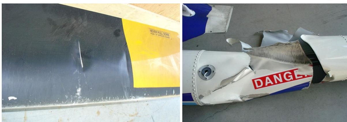
Obr. č. 1: Poškození ocasního nosníku listem nosného rotoru
