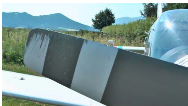
Obrázek 2 Poškození listů vrtule Z 42M
