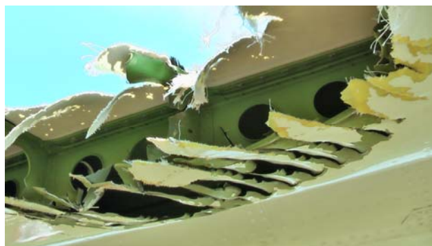
Obrázek 1 Poškození pravého křídélka L 60S
