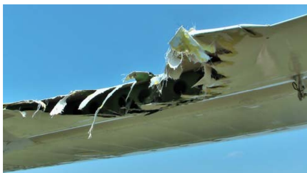
Obrázek 1 Poškození pravého křídélka L 60S
