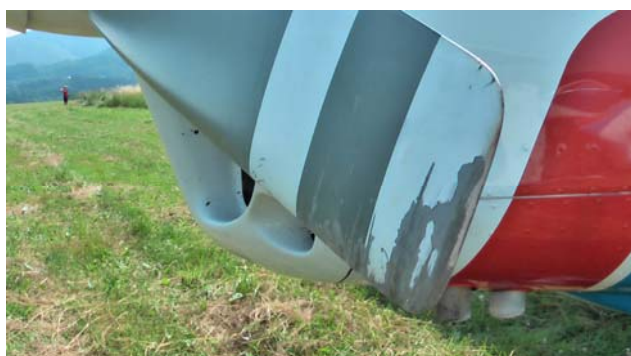
Obrázek 2 Poškození listů vrtule Z 42M
