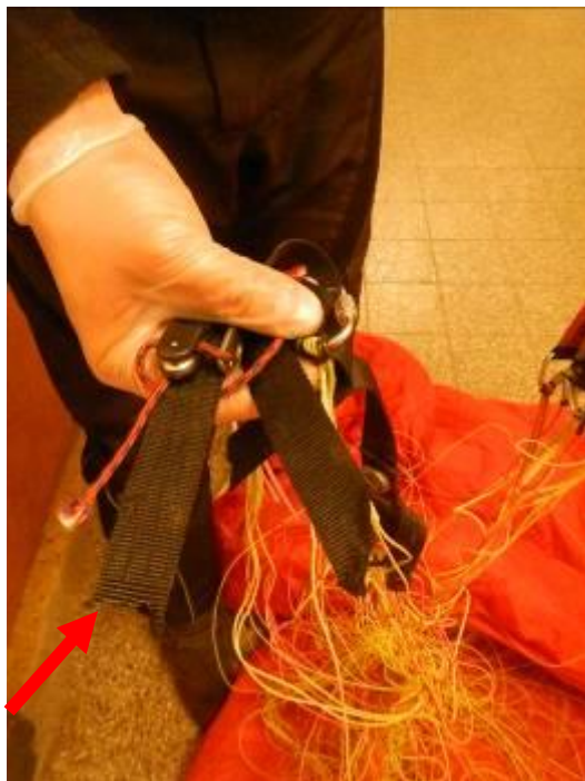
Přefříznutí volných konců – levá strana
