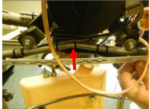
Deformace spojovací příčky
