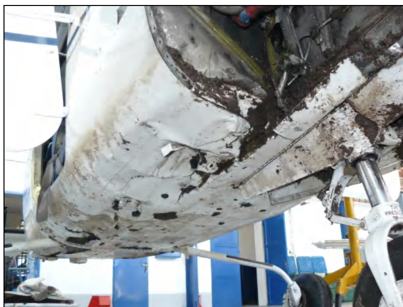
Poškození spodní části trupu
