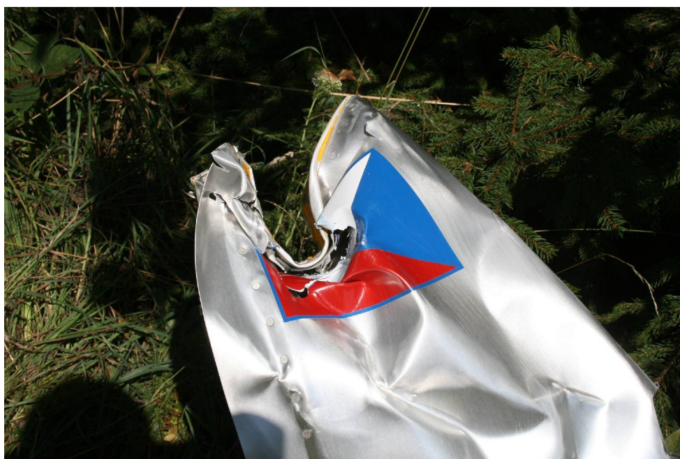
Aerodynamické zakončení kýlové plochy kluzáku L 13 se stopou střetu s křídlem ASK 21
